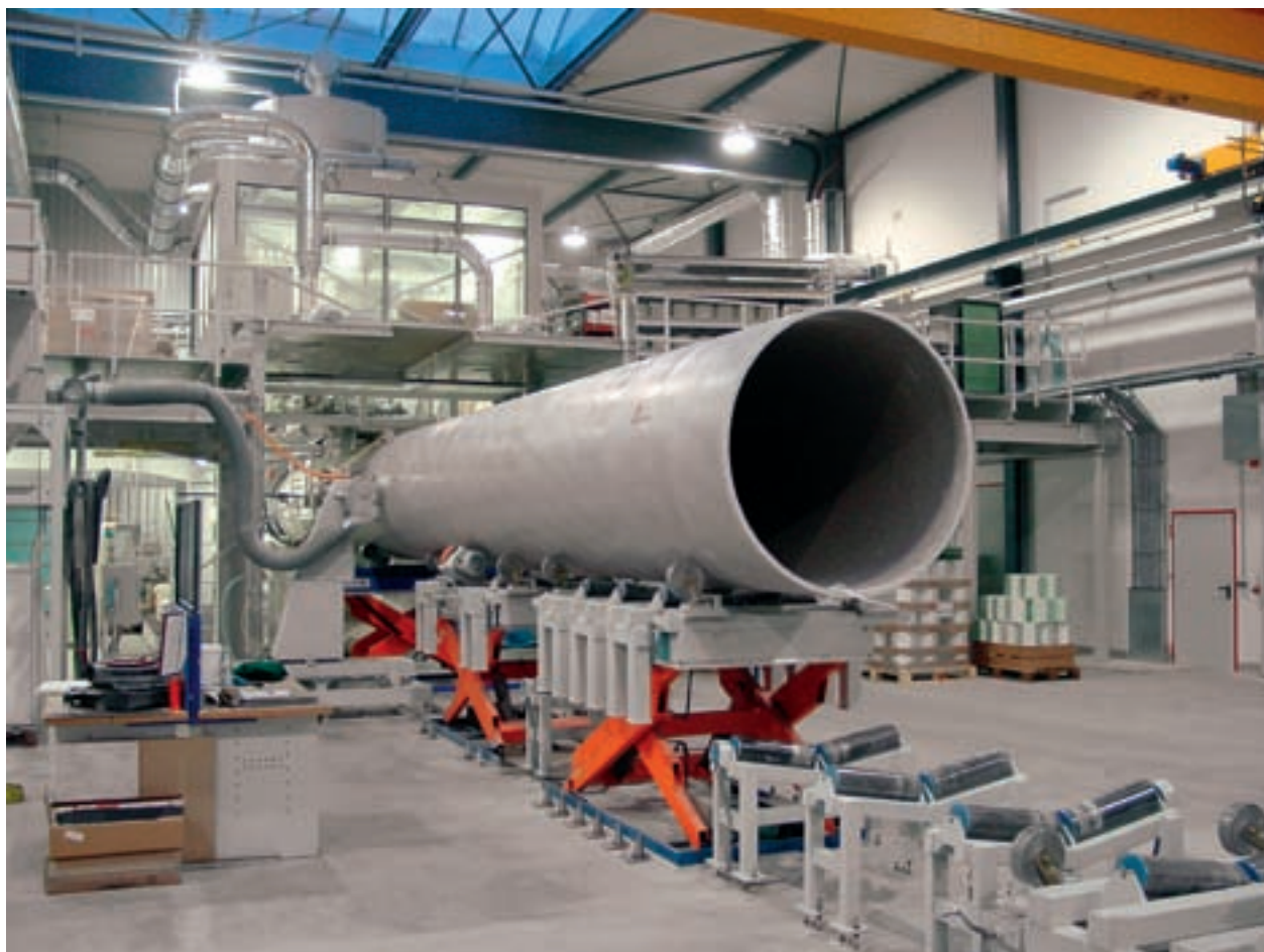
Proces produkcji rur nawojowych GRP
