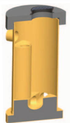
Rysunek 4-5-1 Przykłady studni z zewnętrznym i wewnętrznym przepadem
