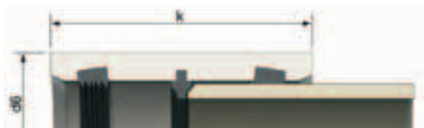
Schemat łącznika kanalizacyjnego FLOWTITE typu FSC w zakresie średnic DN100-250 oraz DN1300-4000
