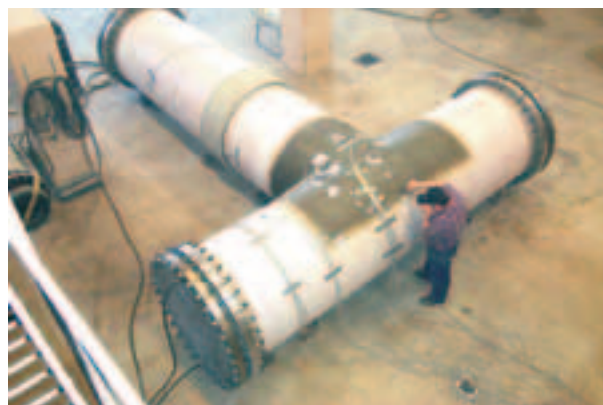
Badania połączenia z laminatu trójnika ciśnieniowego DN 1200/1200, PN6
