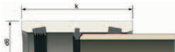
Schemat łącznika ciśnieniowego FLOWTITE typu FPC dla zakresu średnic DN100-4000
