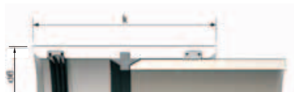
Schemat łącznika kanalizacyjnego FLOWTITE typu FSC w zakresie średnic DN300-1200
